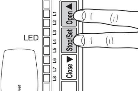
**PROGRAMACION DE ACCESORIOS:** Pulsar OPEN+SET durante 5 segundos para reconocer los accesorios conectados en los bornes de STOP y BLUEBUS
