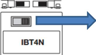
**SENTIDO DE APERTURA:** Vista la instalación desde el interior, mover el selector hacia el lado en el que este colocado el motor.
